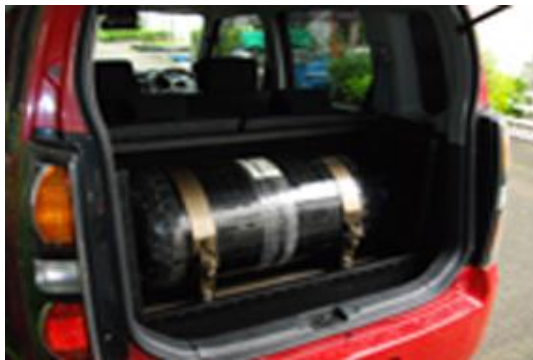
図1 35MPa 軽量高压水素タンクを積んだ試作車
