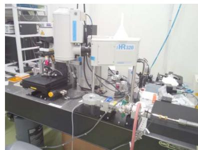
図 2 顕微 PL 装置 (左) と低温用クライオスタット (中央下部)
