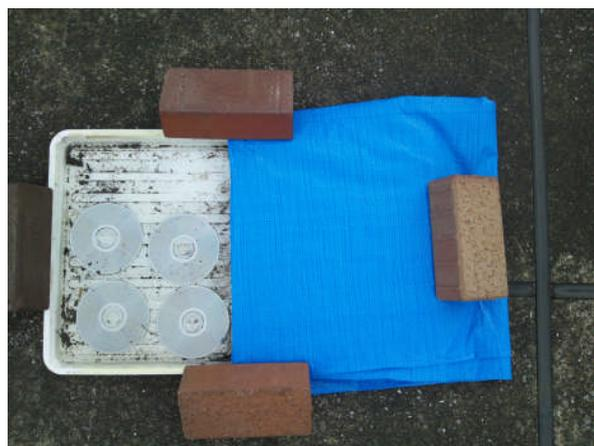
図2 海水・泥水による浸水実験の様子
