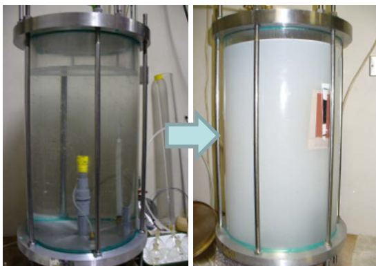
☆直径30 \mu\text{m} の気泡マイクロバブルを特殊ノズルで生成(協力:筑波大京藤教授)
