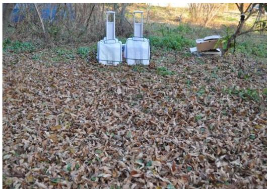
図ー 2 調査場所に設置した音波・超音波発生装置
