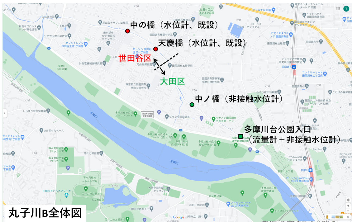
図-2 丸子川 B への観測機器の設置
