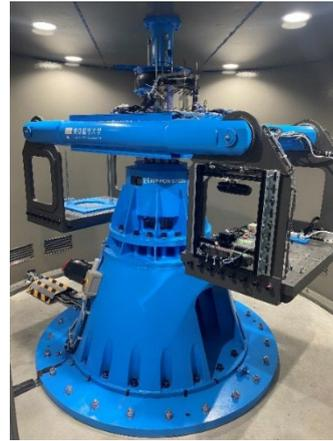
新たに導入された遠心模型実験装置
