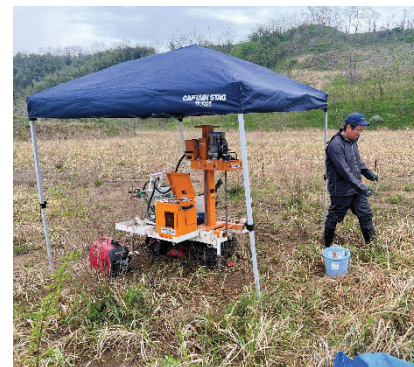
原位置調査 (SDS 試験)
