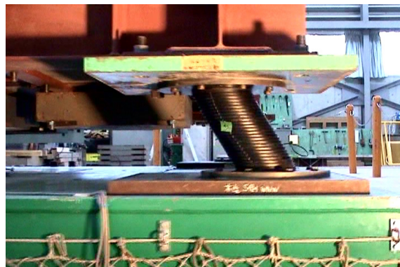
写真2 振動台実験による変形状況と安定性
