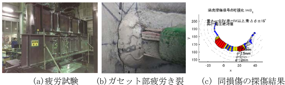
図-2 桁疲労試験体を用いた探傷性能評価実験
